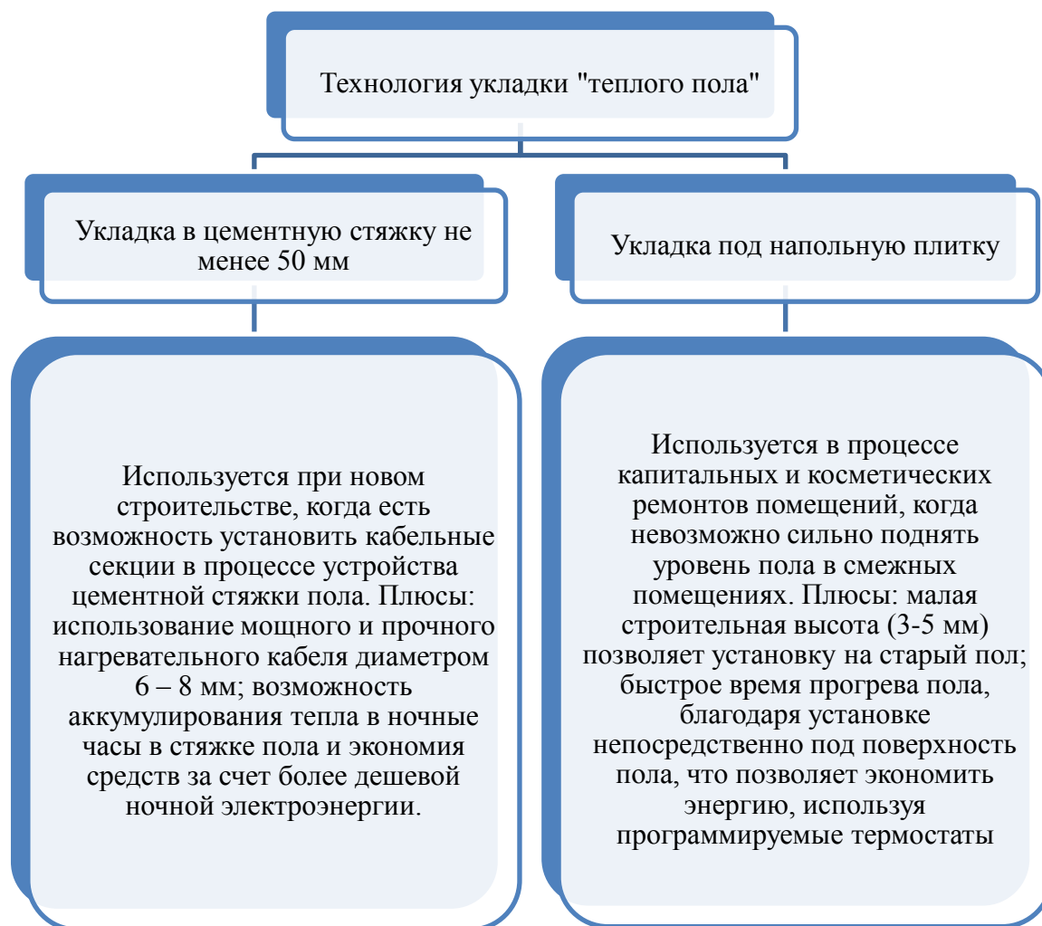
Рис. 4. Основные технологии укладки «теплого пола»
